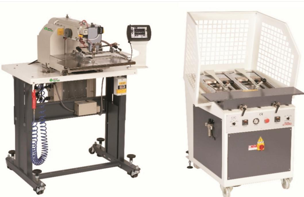
采用缝科PLKG2516花样机头，配4边折烫袋机，适用于中厚料产品的袋盖制作，一次成型，裁好的袋盖放入ST200中进行四边折烫，然后放入袋盖机中自动车缝，无需进行传统的运缝，翻盖，修剪，熨烫，压面线各工序一次成型袋盖，适用于：牛仔面料，斜纹面料等等；
